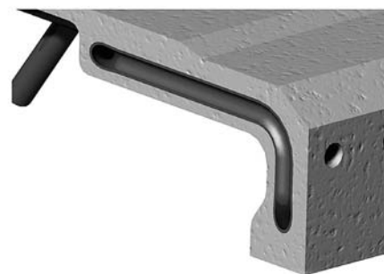
Rostblock wassergekühlt Schnitt durch Gußkörper
